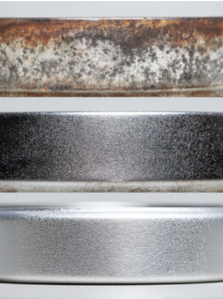
Oben: Werkstück vor der Oberflächenbehandlung, Mitte: Werkstück nach Strahlglasgranulat, unten: Oberflächenfinish mit Strahlglasperlen. Fotocredit: Studio 0816, Midjourney
