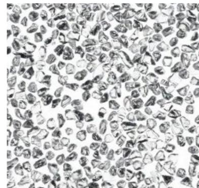
Die scharfkantige Struktur des Granulats ermöglicht eine schnelle und gründliche Reinigung von Metalloberflächen. Fotocredit: SWARCO Indusferica
