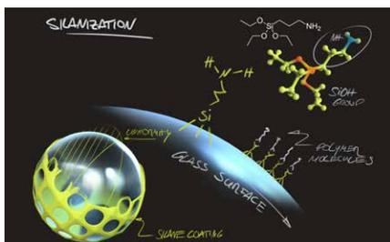
Silanisierung der Oberfläche von Glasperlen verbessert die Anbindung der Einbettungsmatrix.
